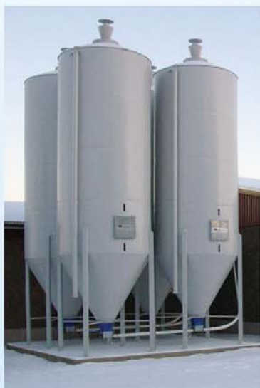
Kuvassa neljän siilon sovellus spiraalikuljettimilla
