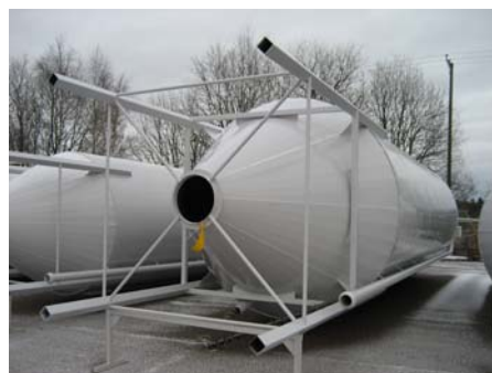
Triotec 38m 3 siilo täyttöruuvilla
