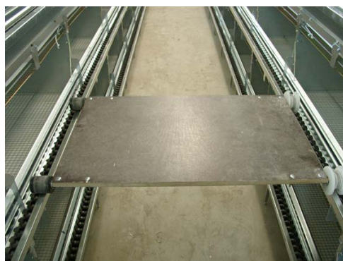
Rehukourun reunaan tuleva hoitoalusta. Rehukourun tukevaa etureunaa voidaan käyttää apuna kiivetessä ylempiin kerroksiin.
