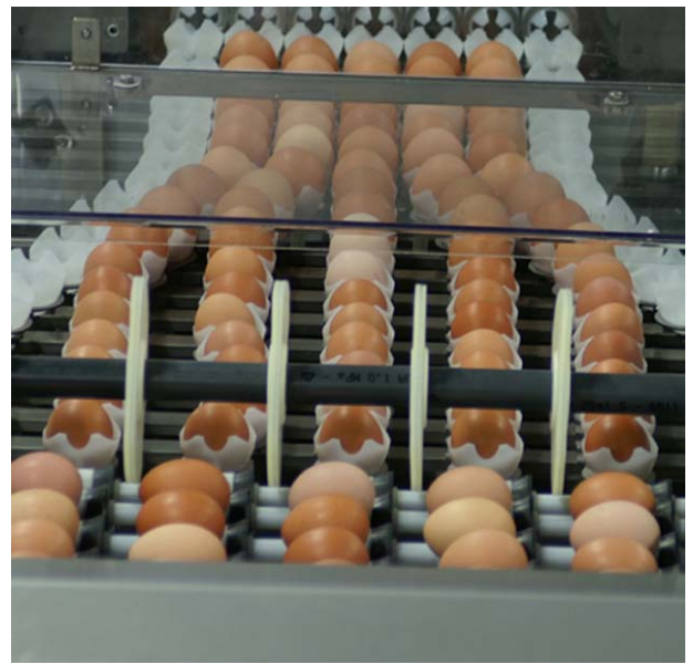
Rullakuljetin, kääntäjä ja kuppikuljetin. Erittäin korkea kääntöprosentti. Munista 99,7% kääntyy tylppä pää ylöspäin.
