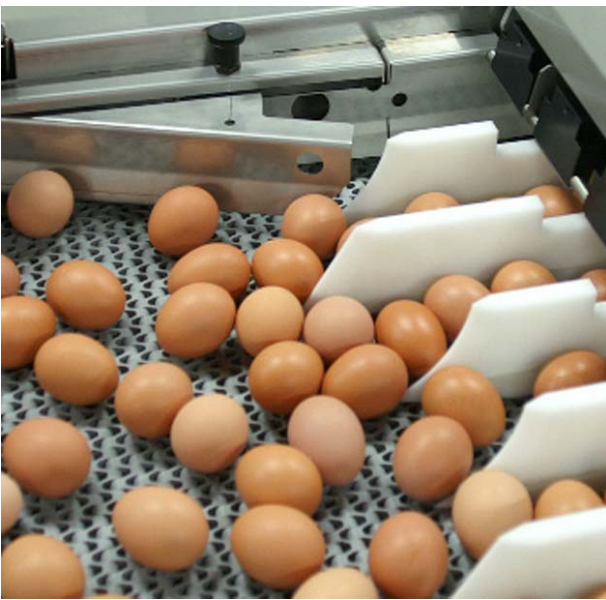
Munat menossa syöttökuljettimelta pakkaajaan.
