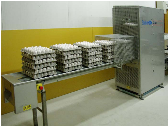
Kaikkiin Staalkatin maatilapakkaajiin on saatavissa kennopinooja. Yksi ihminen voi hoitaa koko pakkaamisen joutuisasti. Yhdistetään pakkauskoneen automatiikkaan. Varmatoiminen ja helppokäyttöinen.
