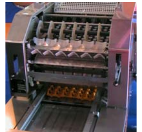
Pakkauspää helppo avata puhdistusta varten. Automatiikka valvoo että, kenno on pakkauspään alla ennenkuin munat tulevat alas.
