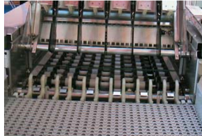
Pakkauspää helppo avata puhdistusta varten. Automatiikka valvoo että, kenno on pakkauspään alla ennenkuin munat tulevat alas.
