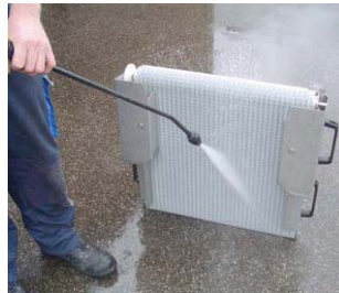
Syöttökuljetin irroitettavissa helposti pesua varten.
