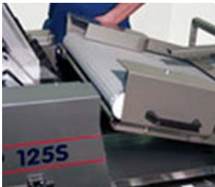
Syöttökuljetin irroitettavissa helposti pesua varten.
