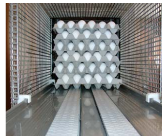
Staalkat kennopinooja tekee siistit pinot. Nopeus riittää reilusti kaikkein tehokkaimmillekin pakkauskoneille. Kapasiteetti 40 000 munaa/h.
