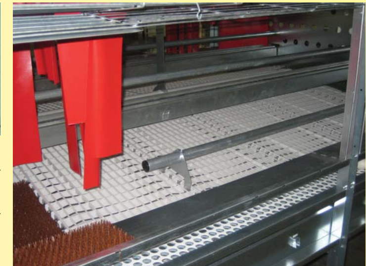
Jansen Volmaxx mini aviary. Jansenin VolMaxx mini aviary tarjoaa hyvän vaihtoehdon kanoille virikehäkki- ja kerrosritiläkanalan välimaastosta. VolMaxxin suunnittelussa on panostettu lintujen käsiteltävyyteen sekä häkin huoltoon että ylläpitoon. Osaston iso koko mahdollistaa rakennuksen pinta-alan optimin käytön. Pesien sijoituksella osaston vastakkaisiin pätyihin mahdollistetaan linnuille suojattu ja rauhallinen ympäristö munimiseen pesässä. Joka osastolta löytyy ketjuruokkijat, kuopsutustila, orret ja kynsiviilat. Tervetuloa tutustumaan laitteistoon tiloihimme.
