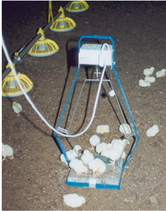
Lintuvaaka DOL 98B -broilereiden ja kalkkunoiden autommattiseen punnitukseen -maks. lintupaino 5 kg -kytketään DOL95 ohjaustietokoneeseen
